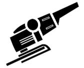
Die Nachbearbeitung mit dem Winkelschleifer ist das flexibelste Gussputzverfahren.
