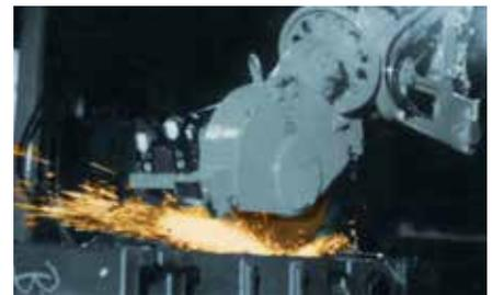
Gussbearbeitung mit Schleifmanipulatoren
