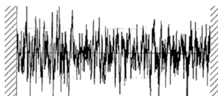
Oppervlakken fjnnslijpen R_a = 0,223
